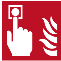
图5 消防设施标志示例（以 GB 13495.1—2015：3-01 “消防按钮”为例）
