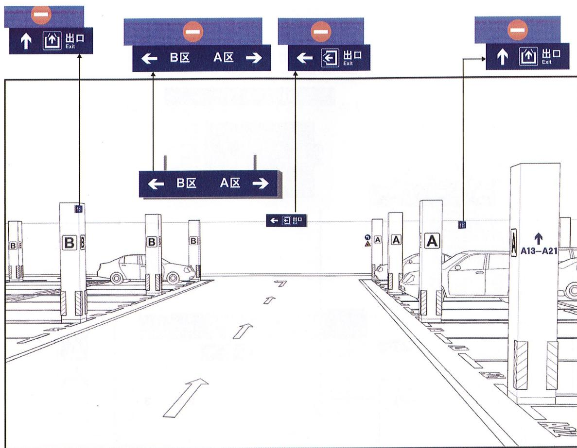
图 A.3 停车场内导向设置示例
