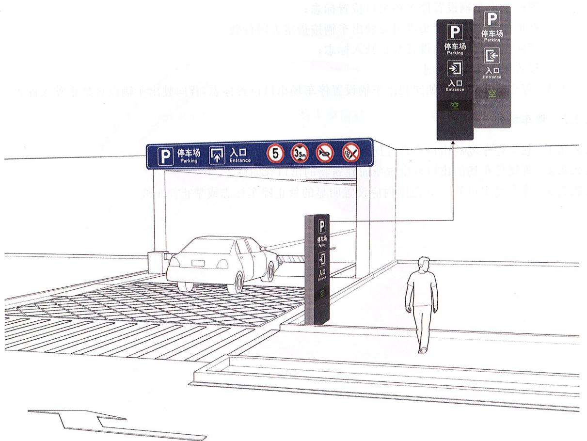
图 A.1 停车场入口导向设置示例
