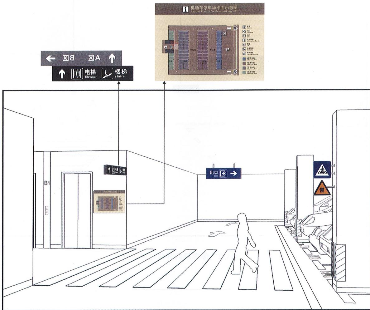
图 A.2 停车场内电梯导向设置示例
