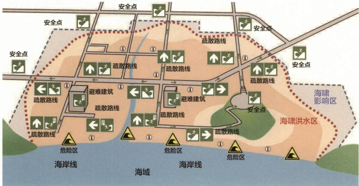
图 D.5 海啸避难导向标志设置示例
