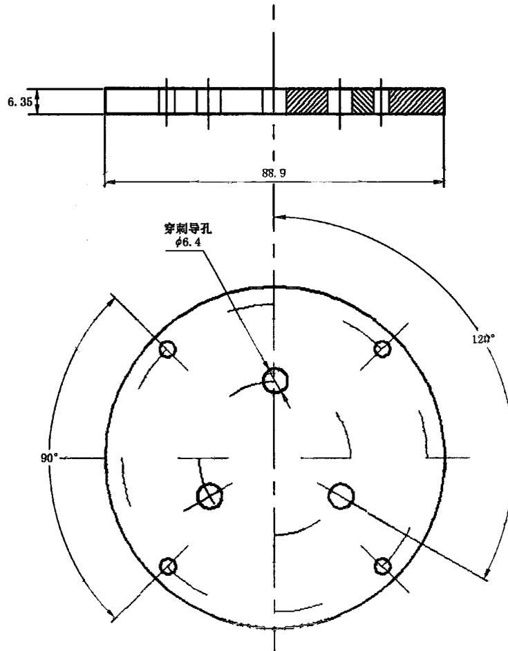
图 3 试样夹板(需要两个)示例
